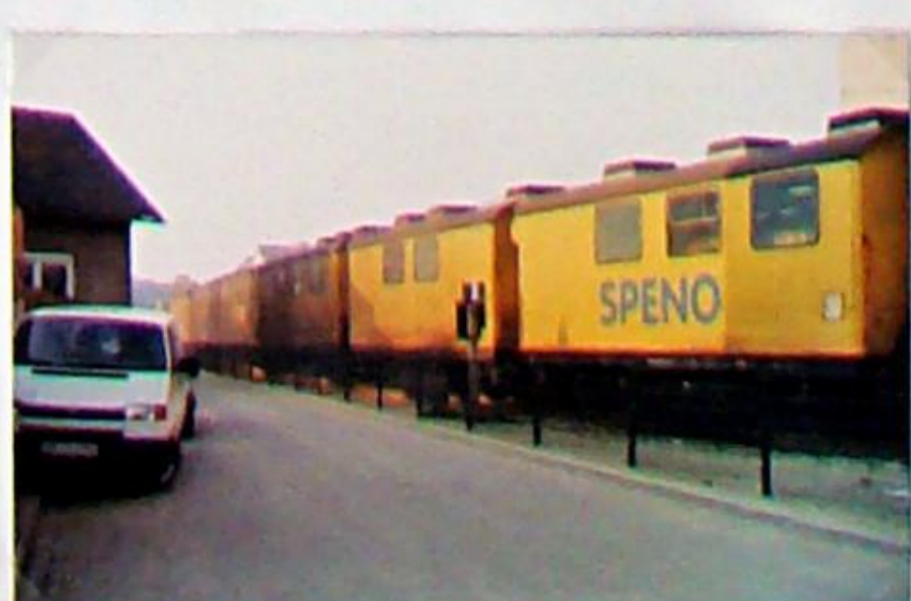
Der achteilige Schienen-schleifzug am 23.4.1994 zwischen Schienenbäcker und Zeughaus Bad Berka im Einsatz
