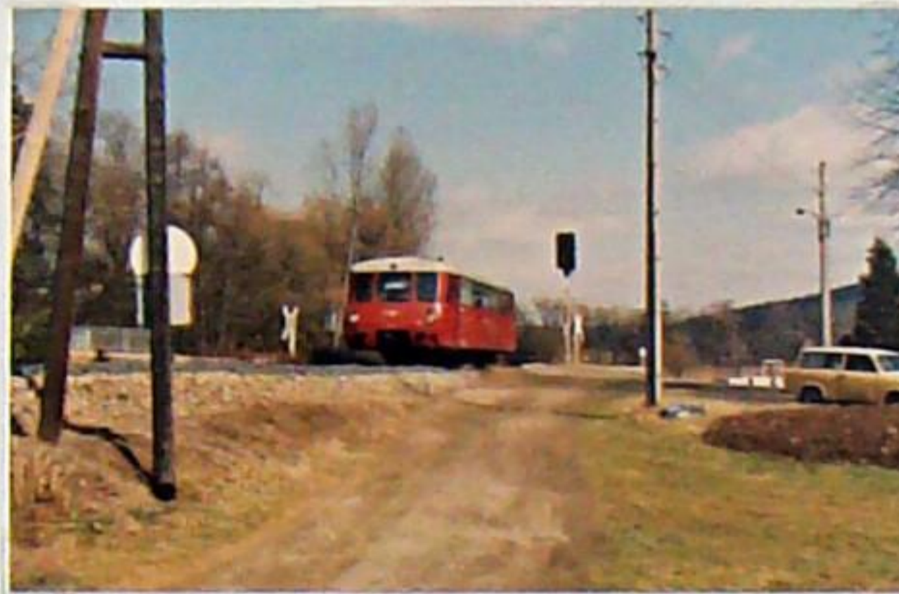
Der starke Güterverkehr erforderte in Bad Berka größere Ausziehlängen vor den Einfahrweichen um Unfälle zu verhindern. Deshalb wurde das Einfahrsignal B als Formhauptsignal 1942 vom alten Standort im Linksbogen um 80 m zurück zum km 17,755 versetzt. Hier als Lichtsignal mit 771 062 am 19.03.1992.
