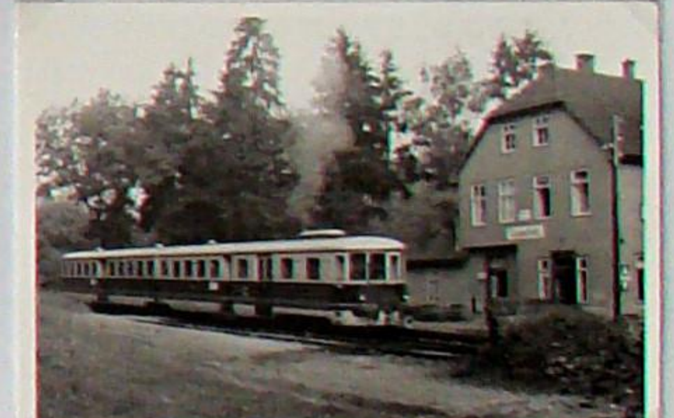
Bei dem 1937/1938 erfolgten Umbau wurde das Diesel-Generator-Aggregat vom Drehgestellrahmen in den „Wagenkasten“ verlagert und dort in einer federnden Wanne befestigt. Durch Überlagerung von Schwingungen zwischen Laufwerk und Motor kam es zum vorzeitigen Verschleiß der Kurbelwellen-Hauptlager. Ab 1938 war der große Schalldämpfer auf dem Dach zu sehen, hier an der Haltestelle Legefeld.
