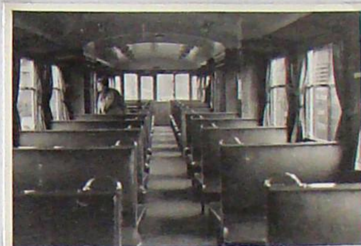
Blick in die hintere Hälfte des Doppeltriebwagens T 05, vom Mitteldrehgestell aus gesehen. An diesem waren die elektrischen 600V-Gleichstrom-Fahrmotoren untergebracht. Trennwände zwischen den Fahrgasträumen gab es zunächst nicht.
