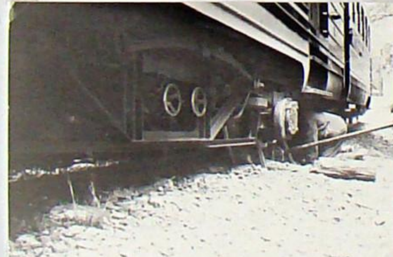
Die anderen Aufnahmen zeigen die gebrochene Radscheibe im entgleisten bzw. ausgebauten Zustand. Ursache dafür waren Lunkenstellen im Stahlguss, die der Achsenhersteller zu vertreten hatte.
