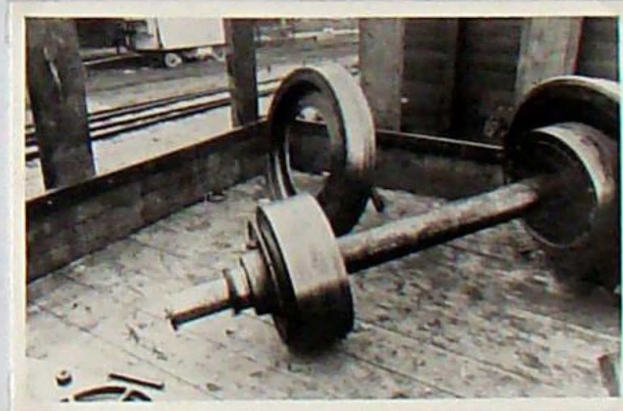
Die anderen Aufnahmen zeigen die gebrochene Radscheibe im entgleisten bzw. ausgebauten Zustand. Ursache dafür waren Lunkenstellen im Stahlguss, die der Achsenhersteller zu vertreten hatte.
