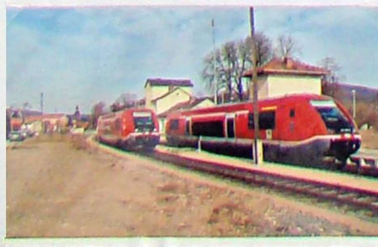
Nach Vorbeifahrt am noch stehenden anderen Triebwagen erfolgt die Verlassensmeldung durch dessen Lokführer und die Anfrage betreffend Weiterfahrt. Nach Zustimmung wird die Schrankenanlage eingeschaltet und danach planmäßig abgefahren.
