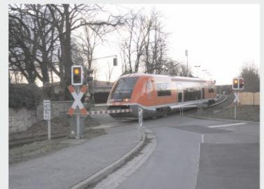
Neue EBÜT-Schrankenanlage am Bf. Holzdorf 2007 Foto: Matthias Geist
