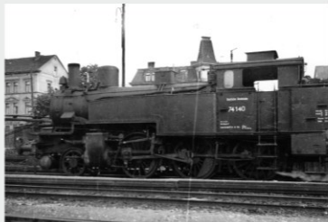
Personenzug-Tenderlok 74 140 des Bw Erfurt-P vor dem Leig im Bf Weimar-B 1953. Als 1°C-Nassdampflok mit Treibrädern von 1500 mm Durchmesser waren diese für die „Berkaer Schiene“ denkbar schlecht geeignet Foto: Georg Hey
