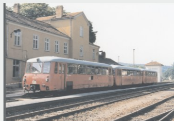
Zwei Maschinen- und ein Steuerwagen als Dreierzug im Bahnhof Bad Berka 1993 Foto: Haase
